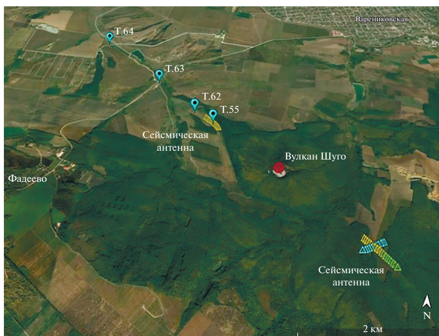
Рис. 1. Расположение вибратора и датчиков при вибрационном зондировании вулкана Шуго: точки зондирования 62, 63, 64, 55, треугольниками обозначены линии расположения линий сейсмоприемников.
