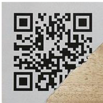
Рис. 4. Пример поврежденного QR-кода, который может быть считан.
