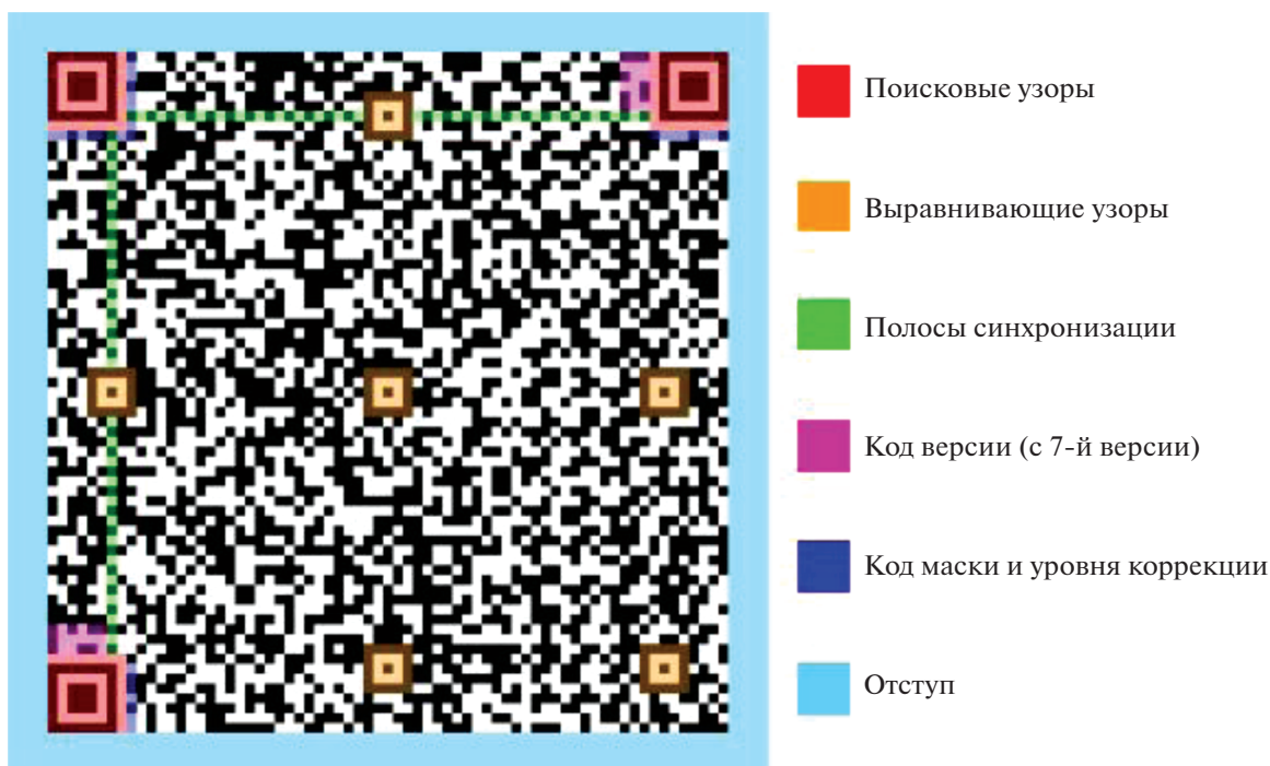
Рис. 6. Структура QR-кода.
