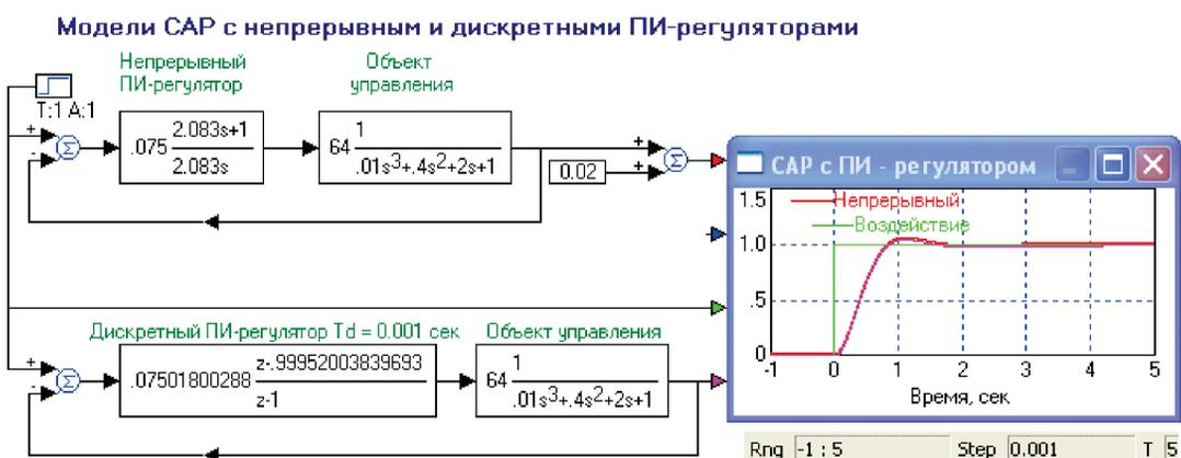
Рис. 4. Выбранный период дискретизации с цифровым управлением непрерывной.
