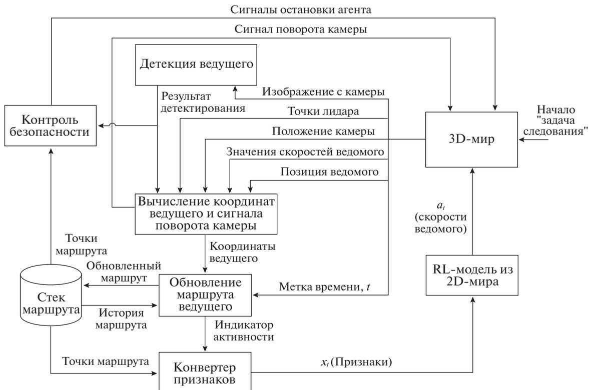
**Рис. 4.** Архитектура системы для решения задачи следования за лидером на базе RL-модели.
