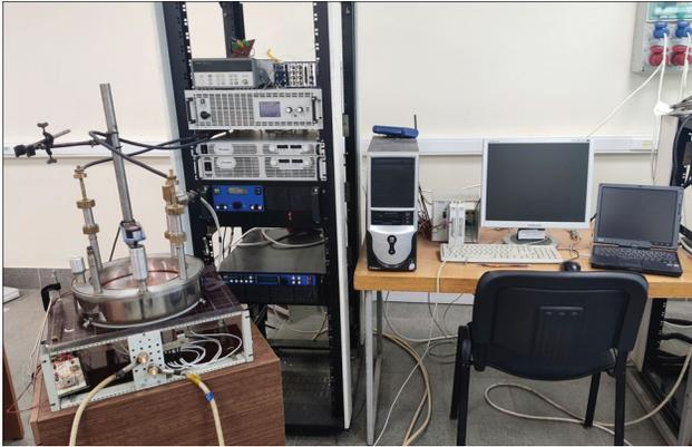
Рис. 1. Испытательная установка униполярного ВТСП-2 электродвигателя.
