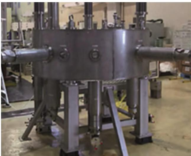
Рис.9. NbTi изохронный циклотрон Sumitomo. Испытания магнитной системы в 2019 г.
