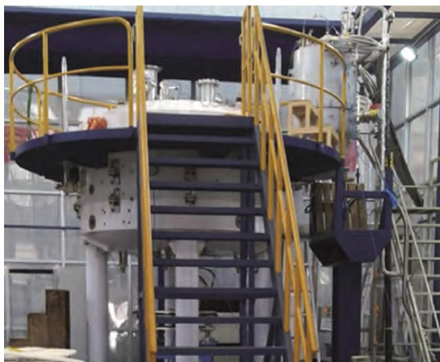
Рис. 10. NbTi изохронный циклотрон SC200 (ОИЯИ)
