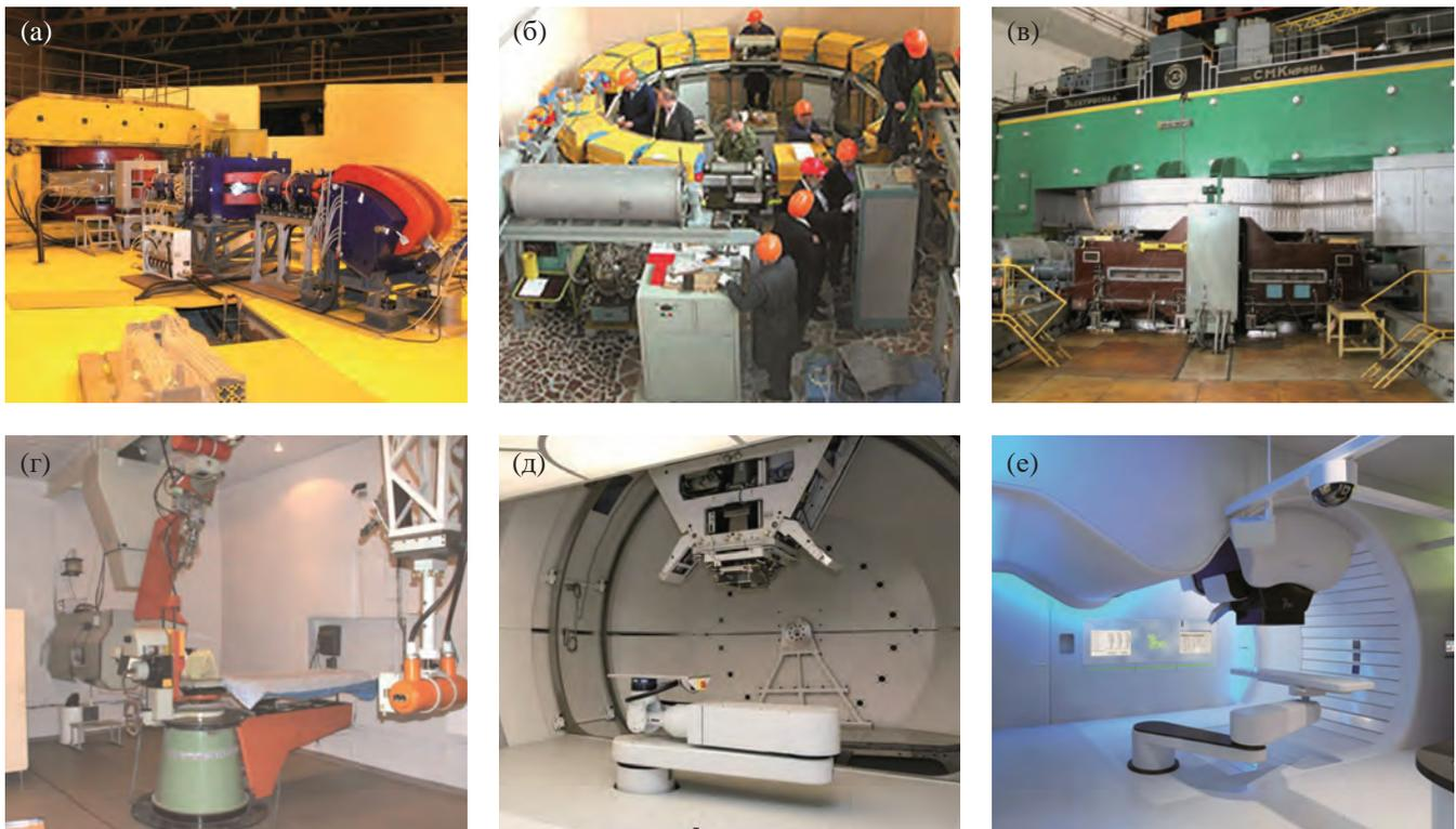
Рис. 5. Российские центры лучевой терапии: циклотрон Ц80 в Гатчине (а), установка Прометеус на базе синхротрона в Обнинске (б), фазотрон в Дубне (в), лучевая установка ИТЭФ в Москве (г), лечебная комната сверхпроводящего циклотрона Varian в Санкт-Петербурге (д), лечебная комната резистивного циклотрона IBA в Димитровграде (е)
