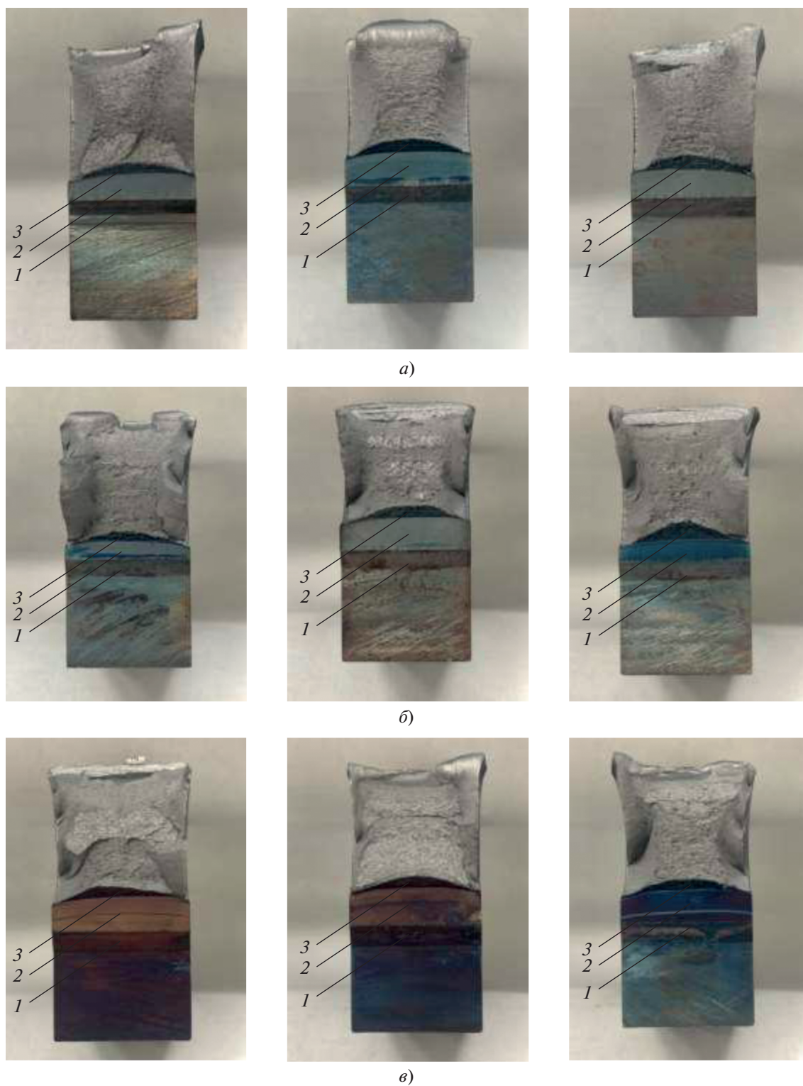
Рис. 4. Изломы испытанных образцов из основного металла (а), металла шва (б) и зоны сплавления (в) из трех партий (в каждом горизонтальном ряду представлены три разных образца из одной партии). Поверхность: 1 – надреза; 2 – усталостной трещины; 3 – статически подросшей трещины
