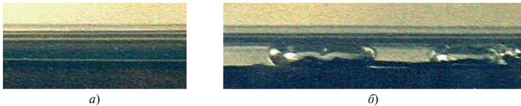
Рис. 5. Расслоенный (а) и снарядный (б) режимы течения в кольцевом канале испарителя
