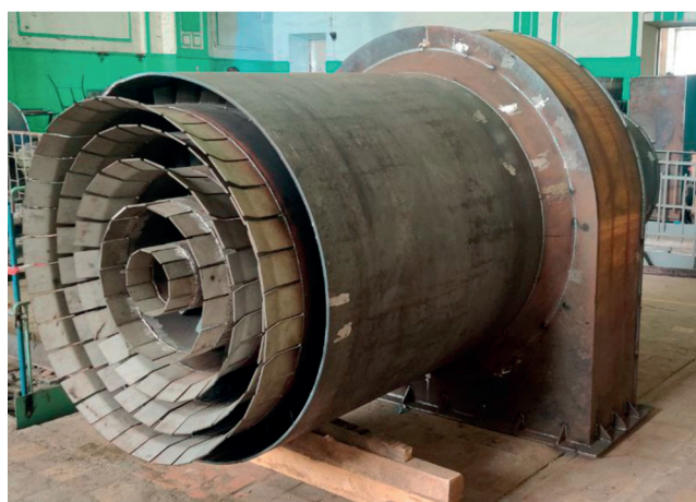
Рис. 9. Горелочные устройства в процессе изготовления ( а–в ) и после монтажа ( г )
