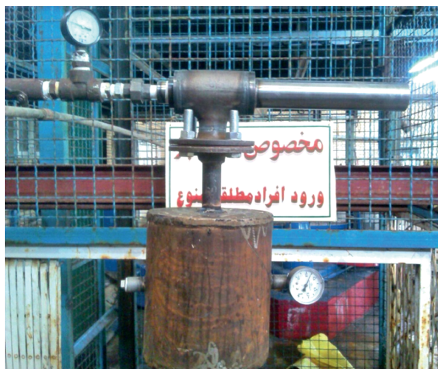
Рис. 17. Внешний вид установки для испытания эжектора
