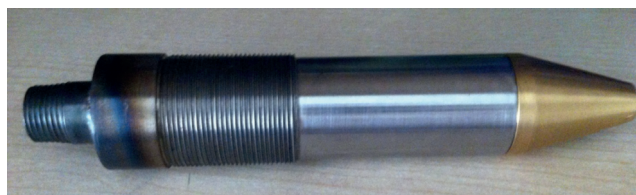
Рис. 15. Сверхзвуковое сопло с держателем
