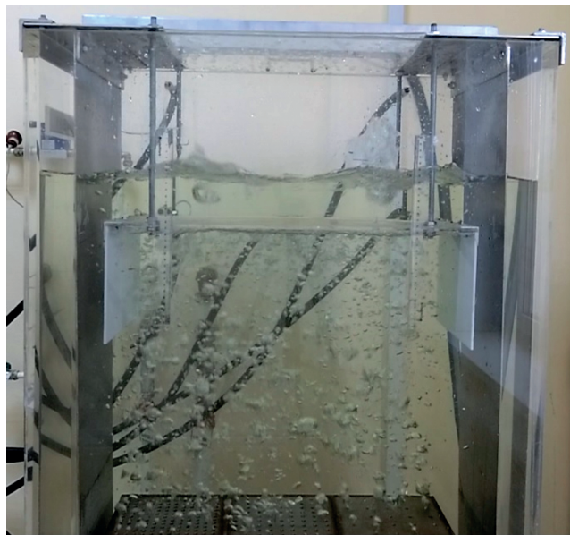
Рис. 2. Общий вид процесса барботажу пузырьков воздуха и образования водяных капель и струй на поверхности раздела
