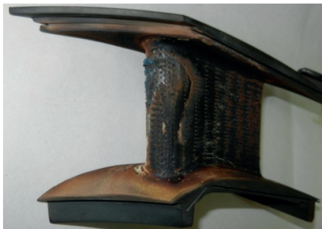
Рис. 1. Прогар сопловой лопатки после испытаний [2]
