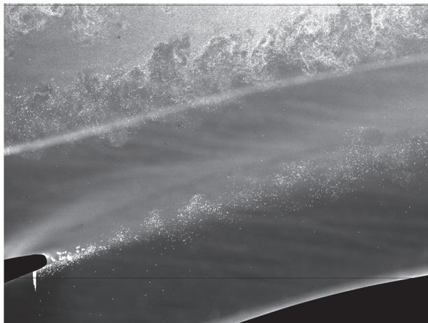
**Рис. 3.** Фотография засвеченных капель за выходной кромкой сопловой решетки
