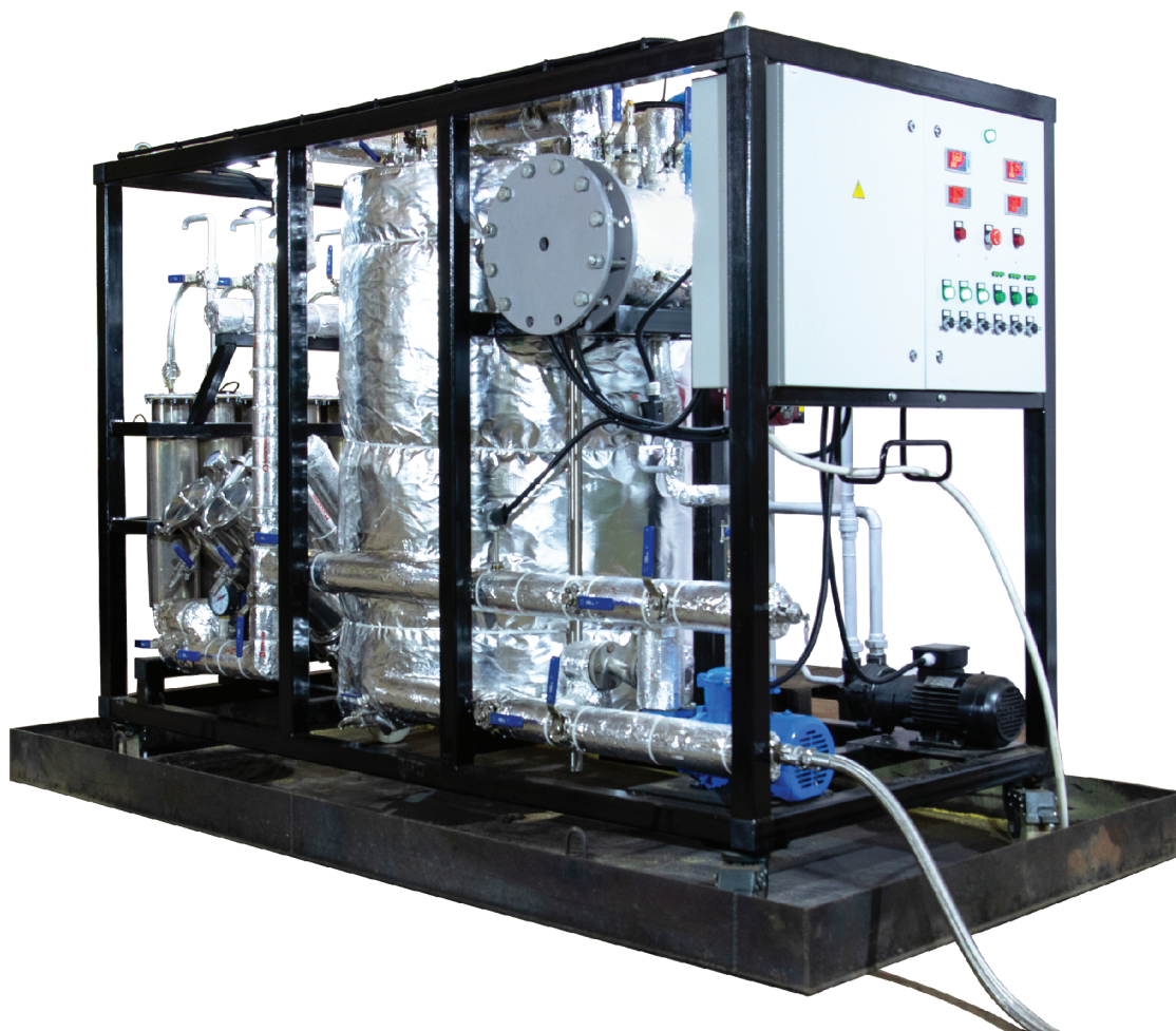
Маслоочистительная установка АО ВТИ
