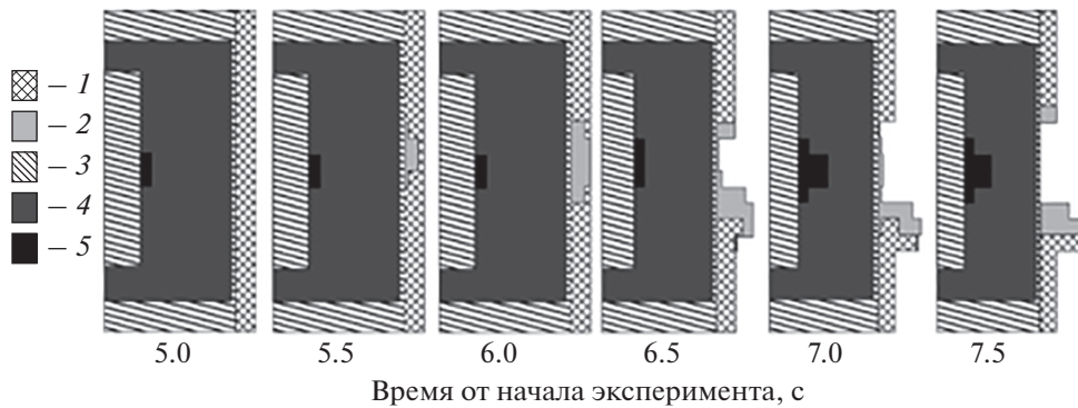
Рис. 8. Карты расчетного распределения материалов твэла в третьем радиальном слое. 1 – сталь твердая; 2 – сталь жидкая; 3 – гелий; 4 – UO_2 ; 5 – UO_2 жидкий
