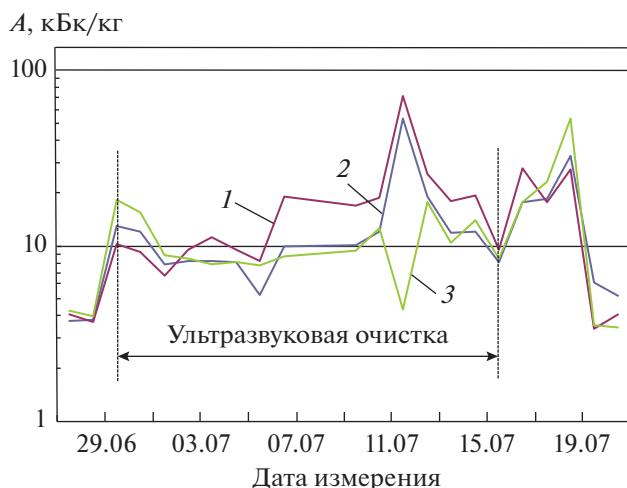
Рис. 7. Изменение удельной активности радионуклидов A в бассейне выдержки Нововоронежской АЭС. 1 – ^{54}\text{Mn} ; 2 – ^{58}\text{Co} ; 3 – ^{60}\text{Co}
