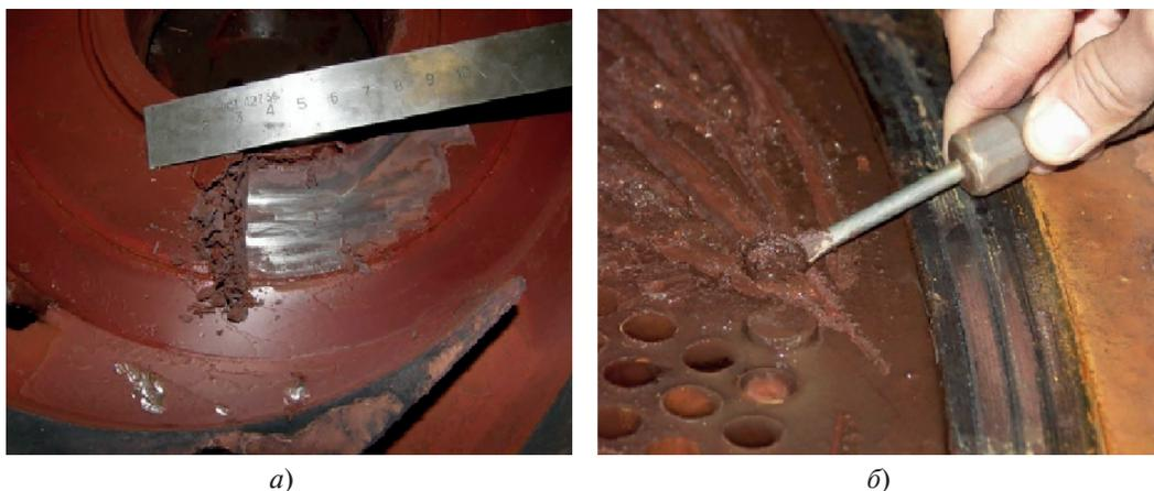
**Рис. 2.** Пластичные железоксидные отложения на низкотемпературных участках конденсатно-питательного тракта [7, 8, 15].
