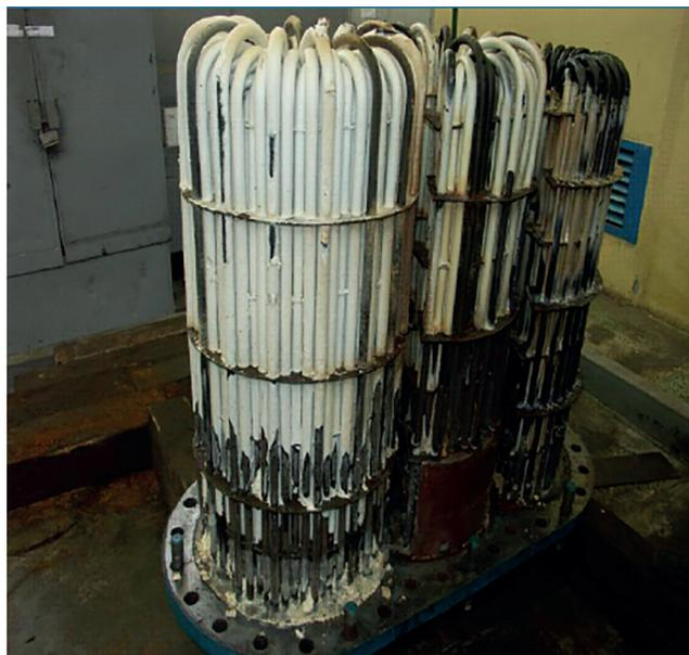
**Рис. 1.** Отложения ОДА на поверхности охлаждающего теплообменника основного эжектора турбины [7, 8, 15]
