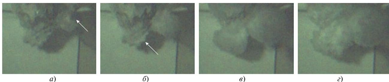
**Рис. 4.** Спонтанный паровой взрыв двух капель расплава NaCl в воде ( $t_{\text{в}} = 18^{\circ}\text{C}$ ,  $t_{\text{NaCl}} = 980^{\circ}\text{C}$ ). Экспозиция – 18.7 мкс. Размер кадров  $40 \times 30$  мм. Белыми стрелками отмечены места триггеринга на каплях. *a* – момент самопроизвольного триггеринга на первой капле; время от кадра *a*, мкс: *b* – 380; *v* – 1380; *z* – 1980
