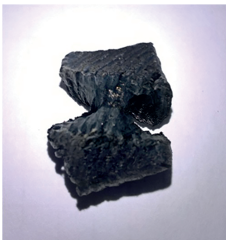
Рис. 4. Растрескавшаяся нефрагментированная коксовая частица
