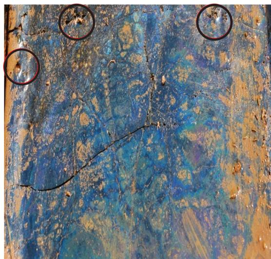
**Рис. 10.** Твердый устойчивый поверхностный слой расплава на верхней поверхности МЛ
