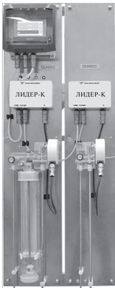
Рис. 7. Внешний вид анализатора примесей “Лидер-АПК”
