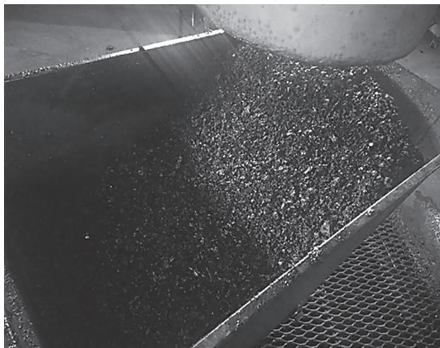
Рис. 9. Полукоксы, полученный в результате экспериментов
