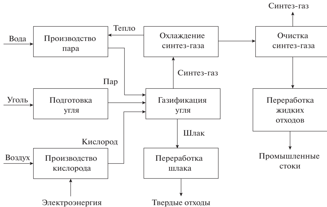
Принципиальная технологическая схема получения синтез-газа из каменного угля
