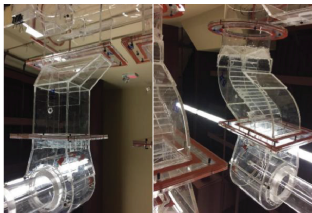
Рис. 4. Элементы физической модели для наблюдения за продувками
