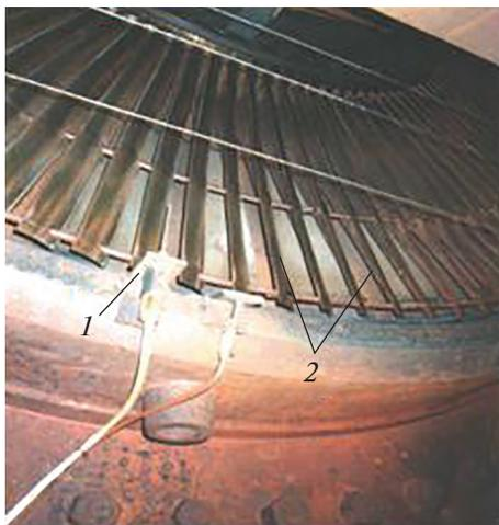
**Рис. 10.** Стационарный электрический зонд, установленный за последней ступенью турбины.
