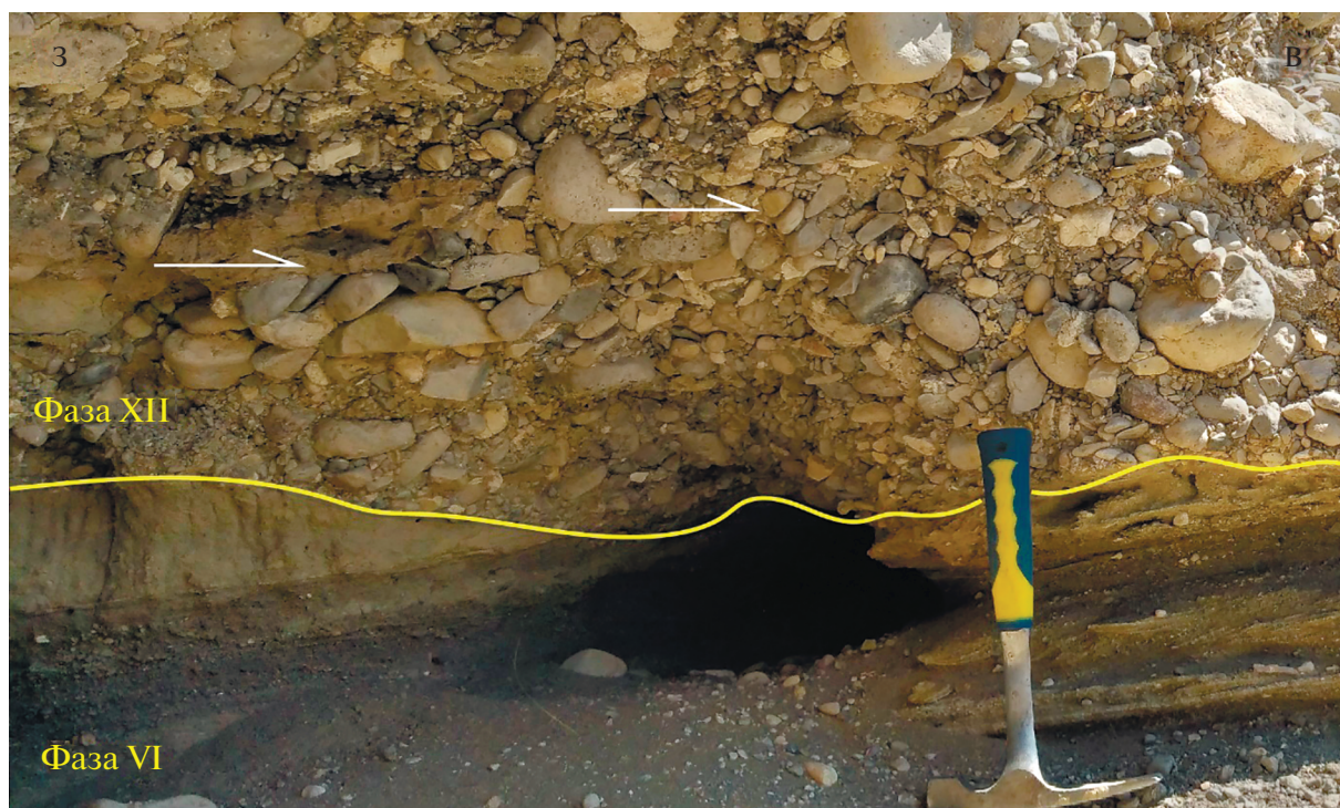
Рис. 10. Слой фазы XII обнажения 58/17, состоящий из плохо сортированных обломков, почти лишенных матрикса, и горизонтально перекрывающий отложения фазы VI развития дельты с эрозионным контактом. Ориентировка обломков (b-axis) указывает на течение воды на восток (белые стрелки).
