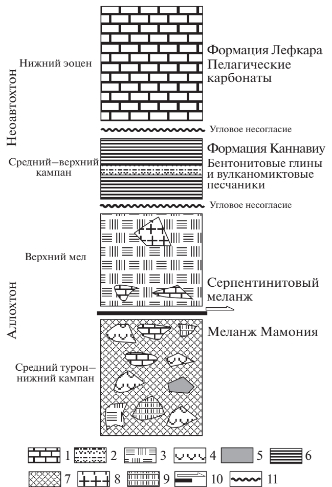
Рис. 6. Разрез, схематически показывающий структурное положение меланжа Мамония в районе Петра ту Ромиу (Bragin et al., 2021). Разрез выполнен вне масштаба. 1 – известняки; 2 – вулканомиктовые песчаники; 3 – серпентиниты; 4 – основные вулканиды; 5 – метаморфиты; 6 – бентонитовые глины; 7 – песчано-глинистый матрикс меланжа Мамония; 8 – диабазы; 9 – кремнистые породы; 10 – надвиг; 11 – несогласие.
