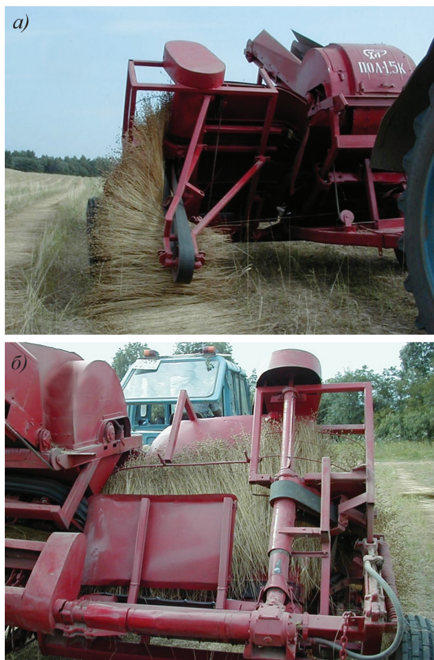
Рис. 2. Подборщик-очесыватель ПОЛ-1,5К в работе: а) вид спереди; б) процесс выравнивания ленты льна.
