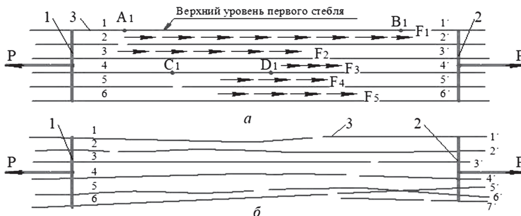
Рис. 1. Схемы взаимного расположения и взаимодействия группы (слоя) стеблей при растяжении: 1, 2 – захваты; 3 – стебли; P – растягивающие силы.
