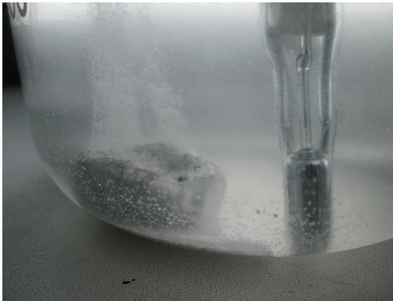
**Рис. 6.** Фотография начала взаимодействия активированного алюминия с дистиллированной водой.
