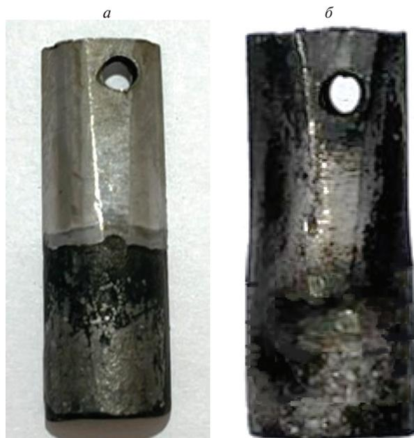
**Рис. 2.** Внешний вид молибденовых покрытий на образцах стали 12X18H10T из хлоридных (а) и фторидных (б) расплавов.
