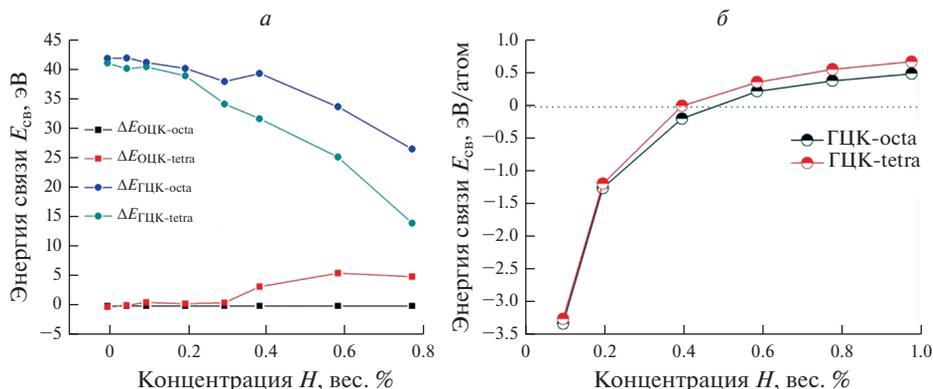
**Рис. 7.** а) различие энергий связи как функция содержания водорода для ОЦК и ГЦК структур, обозначения ОЦК-octa., ОЦК-tetra., ГЦК-octa. и ГЦК-tetra. относятся к заполнению водородом октаэдрических/тетраэдрических междоузлий ОЦК/ГЦК TiZrHfMoNb; б) расчетная энергия связи для ГЦК гидридов TiZrHfMoNb (обозначение те же) [177].
