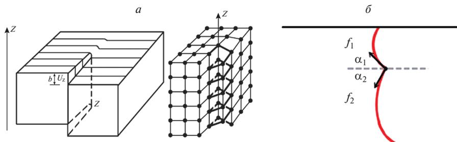
**Рис. 2.** Схема геометрии дислокации вокруг локального точечного пиннинга. *а)* упрощенная модель торможения движения линейной и винтовой дислокаций в кристаллах; *б)* торможение дислокации с приближением к точке пиннинга (указаны стрелками  $\alpha_1$  и  $\alpha_2$ ), как локального препятствия – потенциального барьера на фоне структурного ландшафта [1].
