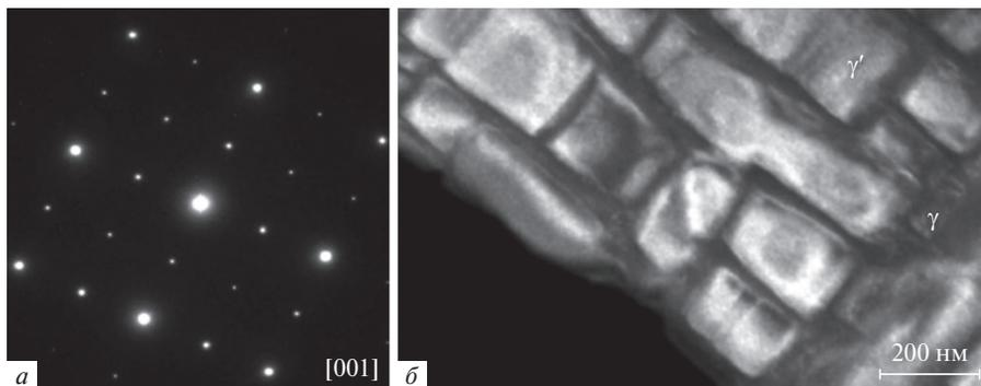
**Рис. 1.** а) Типичная электронная дифракционная картина выбранной области сплава с 2 ат. % Cr от оси зоны [001], показывающая крупные пятна сверхрешетки от выделенной упорядоченной фазы  $L1_2$  и более мелкие пятна от основных отражений  $\gamma$ -матрицы; б) микроструктурная/кубовидная морфология  $\gamma'$ - и  $\gamma$ -фазы матрицы после 50 часовой закалки при  $900^\circ\text{C}$  [33].
