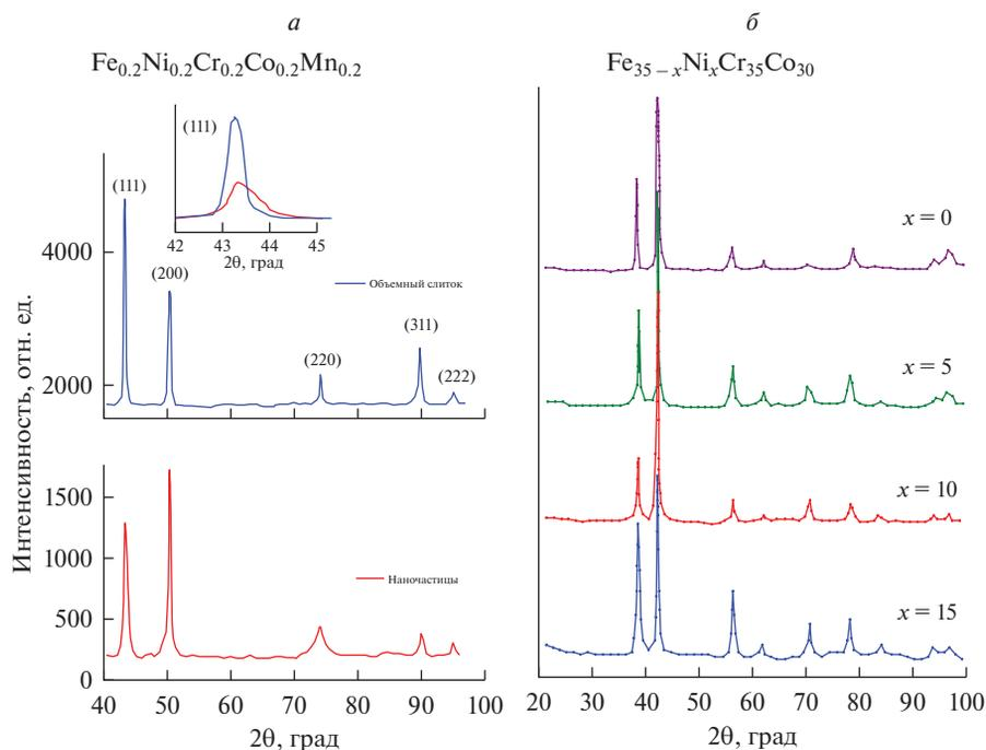
**Рис. 5.** Рентгеновские дифрактограммы сплавов: а) высокоэнтропийного сплава  $\text{Fe}_{0.2}\text{Co}_{0.2}\text{Cr}_{0.2}\text{Mn}_{0.2}\text{Ni}_{0.2}$  в виде наноразмерного порошка и объемного слитка [2]; б) нанокристаллического сплава  $\text{Fe}_x\text{Co}_{35-x}\text{Nb}_{30}\text{Ti}_{35}$  ( $x = 0, 5, 10, 15$ ) [80].
