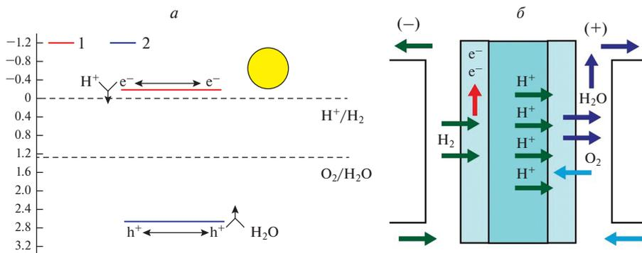
**Рис. 6.** а) краевая полоса зонной структуры  $V_S$  (эВ); схематическая диаграмма положения края полосы монослоя  $p$ - $Si_2C_4$ -4H, рассчитанная на основе DFT-функционала [19, 162]; б) принцип действия водородного электрогенератора, основанный на реакции окисления водорода [163].
