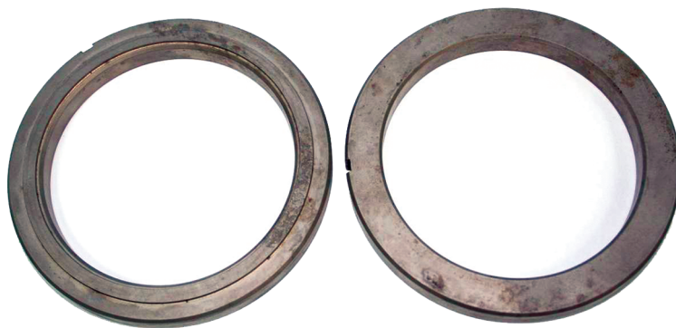
Рис. 10. Борированные детали из стали 20X13.
