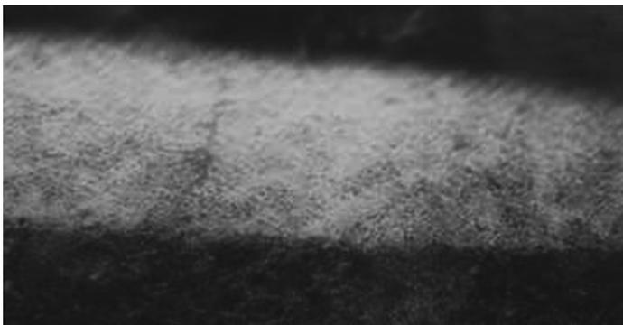
Рис. 9. Микрофотография поверхности стали марки 38ХВФЮА после лазерной обработки: “белый слой”.
