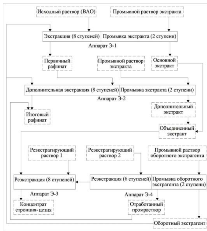
Рис. 8. Вариант аппаратурно-технологической схемы установки УЭ-35 с замывкой рафината дополнительным потоком оборотного экстрагента.
