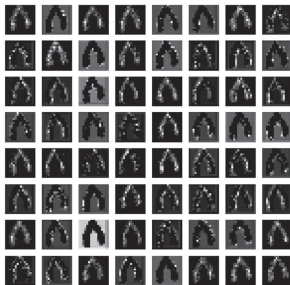
Рис. 5. Визуализация карт признаков слоя обученной нейронной сети предложенного варианта с 64 фильтрами. Количество повторяющихся образов по сравнению с исходным вариантом, приведенным на рис. 4, снижено. Полностью незначимые фильтры отсутствуют.
