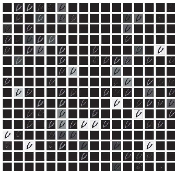
Рис. 4. Визуализация карт признаков слоя обученной нейронной сети классического варианта с 256 фильтрами. Полностью незначимые фильтры показаны черным цветом.
