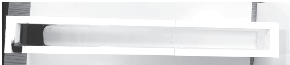
Рис. 2. Фото экспериментальной кюветы с нанесенной на воду нефтью и убранной перегородкой.
