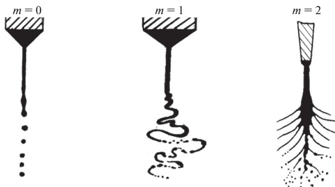
Рис. 1. Зарисовки режимов электродиспергирования жидкости в различных азимутальных модах по результатам экспериментов [23].
