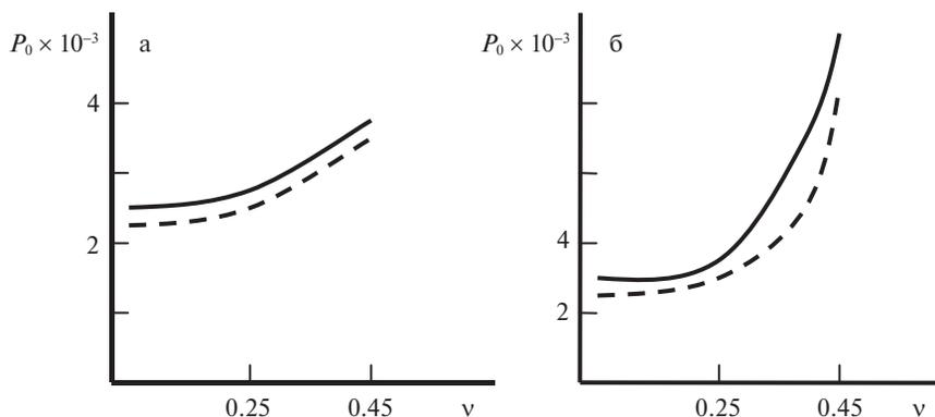
**Рис. 2.** Зависимость безразмерной вдавливающей силы  $P_0$  от коэффициента Пуассона  $\nu$  для задач А и  $A_1$  (а) и Б и  $B_1$  (б);  $\delta_0 = A_0 = B_0 = 0.001$ ,  $\epsilon = 1$ ,  $\lambda = 0.25$ , пунктир для задач  $A_1$  и  $B_1$ .
