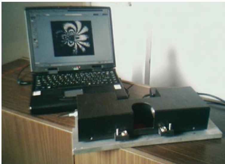
Рис. 14. Мобильный спекл-интерферометр для измерения остаточных напряжений (2000 г.).
