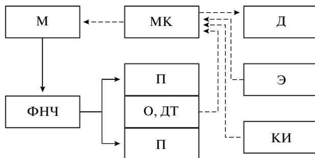
**Рис. 2.** Блок-схема термостата. МК – микроконтроллер; М – H-мост; ФНЧ – фильтр нижних частот; П – элементы Пельтье; О – образец; ДТ – датчики температуры; Д – дисплей; КИ – компьютерный интерфейс. Сплошными линиями показаны силовые соединения, штриховыми – слаботочные аналоговые или цифровые каналы.
