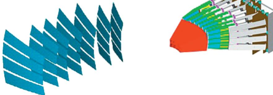
Рис. 4. Форма и расположение детектирующих поверхностей (слева) и вид плеча регистрации (справа) детекторной системы АСТРА.
