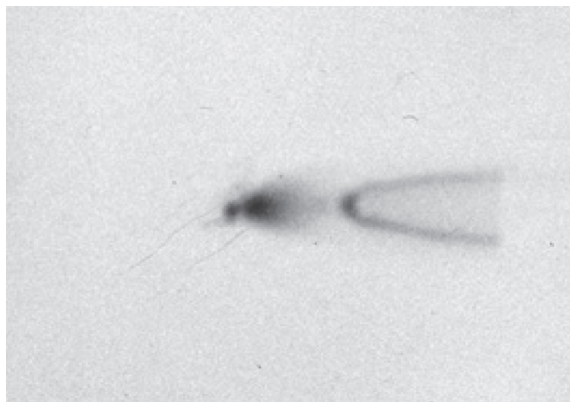
Рис. 2. Рентгеновская обскурограмма межэлектродного промежутка, зарегистрированная при следующих условиях: в момент инициирования разряда внутренний электрод — анод, внешний электрод — катод, длина формирующей линии 1 м.
