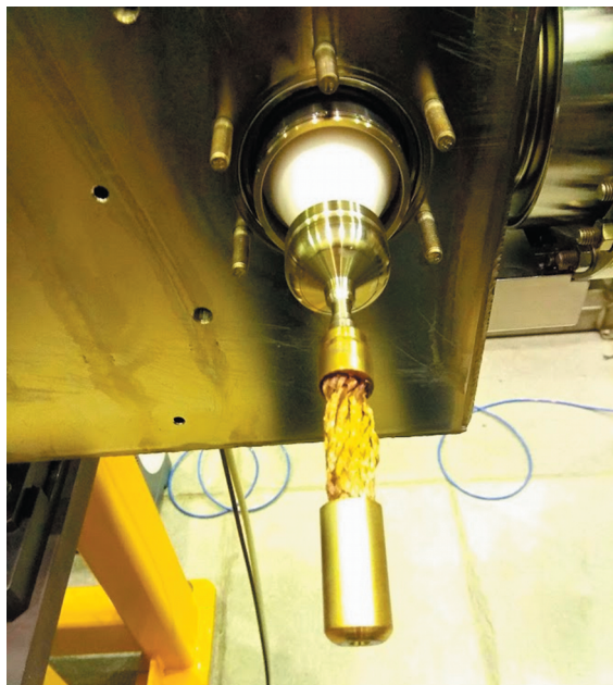
Рис. 7. Генераторная часть токоввода с гибким контактом.
