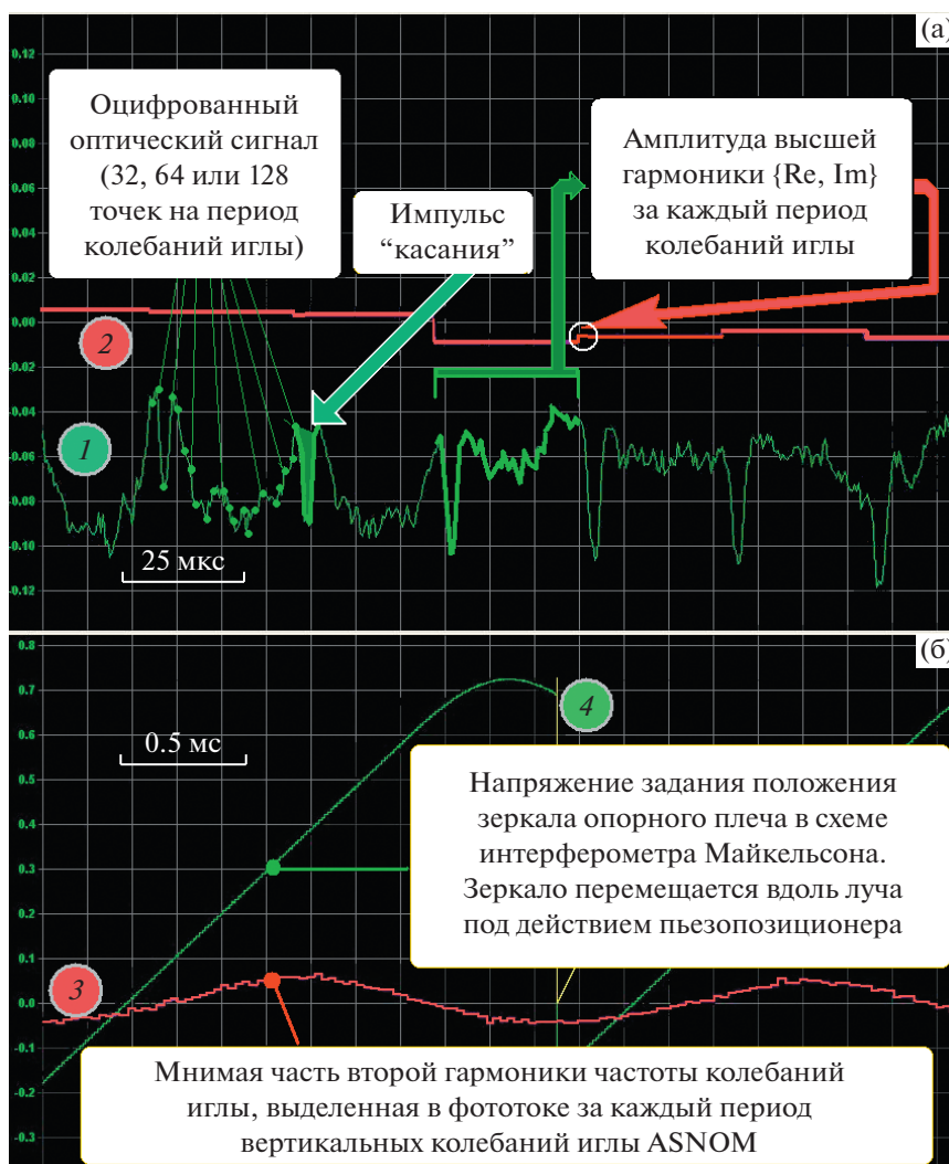
Рис. 4. Отображение на экране виртуального осциллографа данных, соответствующих различным этапам цифровой обработки сигнала: а — исходные данные (луч 1), полученные в виде пакета от а.ц.п. (хорошо виден пик, возникающий в момент касания Pt-иглой поверхности SiC, имеющей сильный ASNOM-отклик благодаря совпадению частоты решеточного резонанса SiC с оптической частотой излучения CO 2 -лазера; суммарная амплитуда этого пика в конце каждого периода колебаний иглы выводится также на экран (ступенчатая линия — луч 2, он же луч 3 в б ); б — луч 3 — результат первичного детектирования из части ( а ) на протяжении всего полупериода колебаний модулирующего зеркала (координата зеркала отображена линейно нарастающим лучом 4), зависимость измеренного ближнепольного сигнала от времени (от положения зеркала) носит синусоидальный характер.
