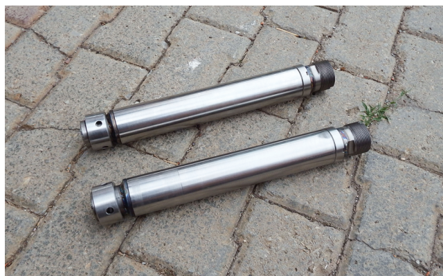
Рис. 3. Герметичный контейнер с аналого-цифровым преобразователем.
