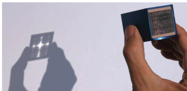
Рис. 18. Изображение Солнца в видимом свете, полученное с помощью миниобъектива “глаза лобстера” в геометрии Шмидта [229].
