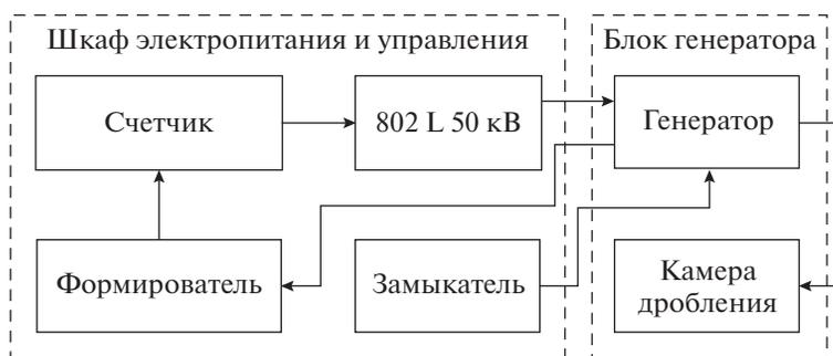
Рис. 19. Блок-схема генератора.
