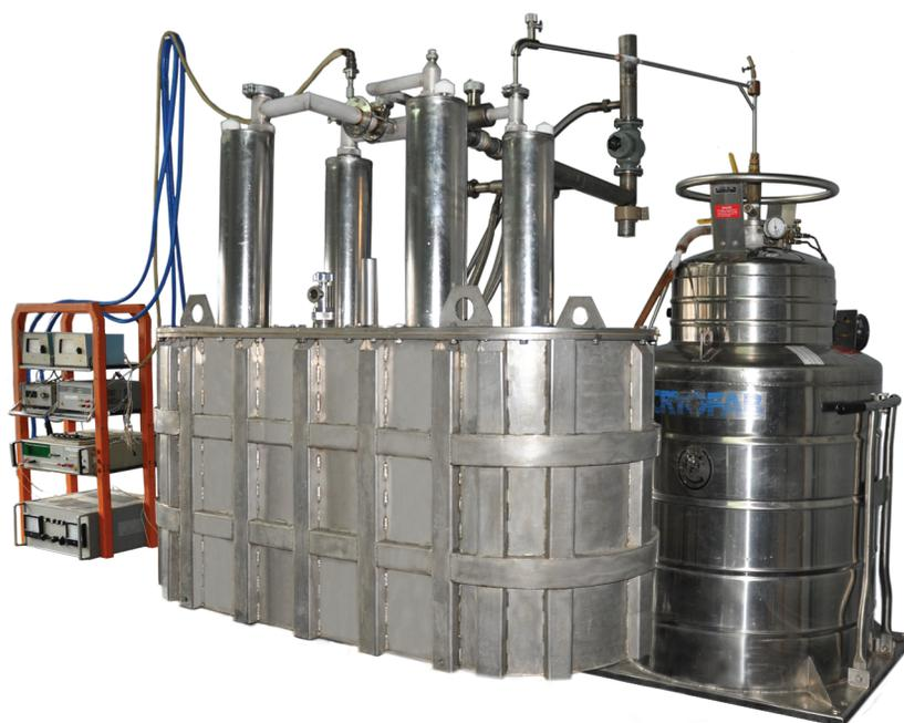
**Рис. 3.** Внешний вид криомагнитной системы.
