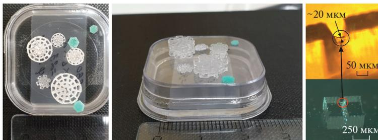
**Рис. 4.** Фотографии тестовых структур (слева и в центре), сформированных методом двухфотонной полимеризации с использованием пространственно-временной фокусировки (структуры белого цвета) и классической схемы (зеленого цвета). Справа приведена фотография фрагмента структуры с демонстрацией разрешения при рабочих параметрах (20 мкм).
